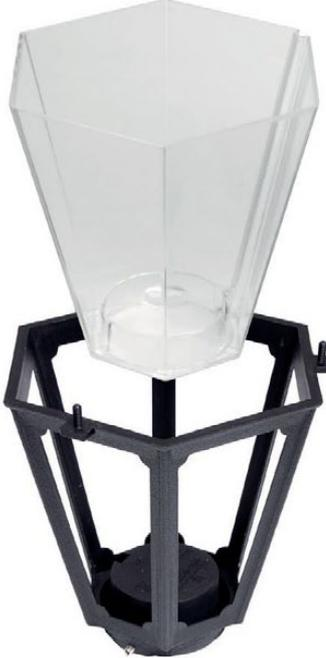
**DIFUSOR** hecho de polimetilmetacrilato estabilizado a los rayos UV (PMMA) resistente al proceso de amarillamiento debido a los rayos solares, disponible en color transparente u opal y provisto de un receso para el suministro de cable de alimentación. Hecho de una sola pieza y cerrado en la parte inferior para garantizar una alta protección contra agentes externos (IP 55).
